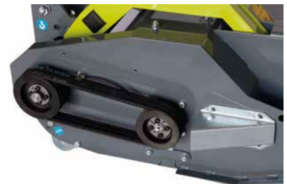
3 v-snaren Beveiliging V-snaardeksel
